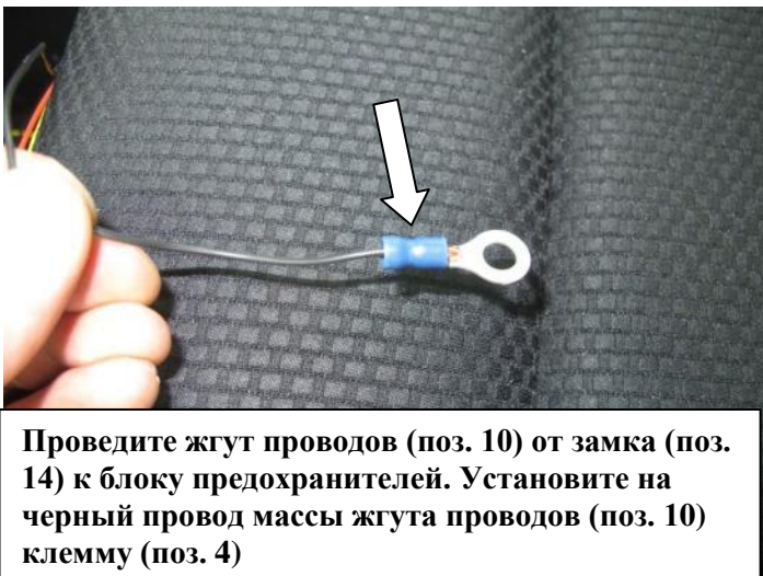
Обожмите клемму (поз. 4) на черном проводе массы жгута проводов (поз. 10)
