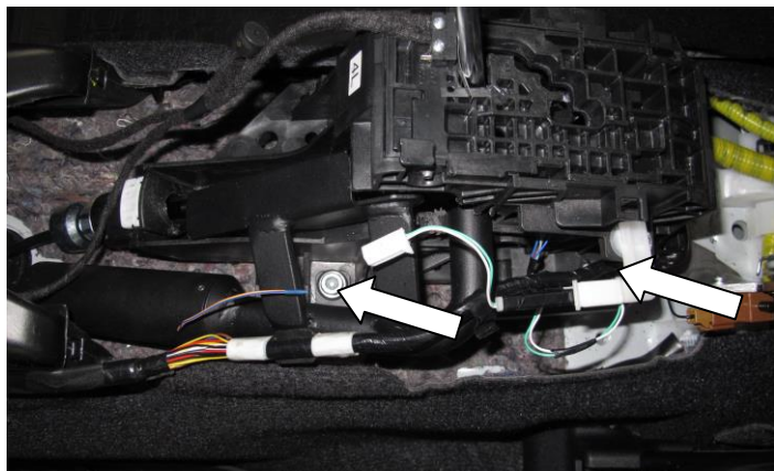
Установите замок (поз. 1) и прикрутите болтами (поз. 15, 16) с шайбами (поз. 17)
